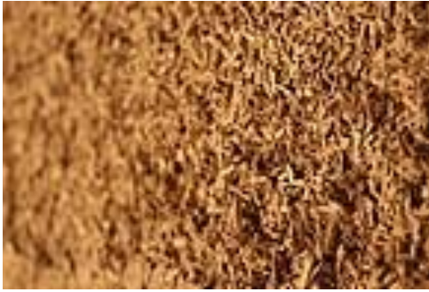
Wände aus Hanfkalk: Der Baustoff ist wärmedämmend, kreislauffähig, schwer entflammbar, schimmelresistent, unattraktiv für Schädlinge und schadstofffrei. Bildquelle: Universität Hohenheim/Corinna Schmid
